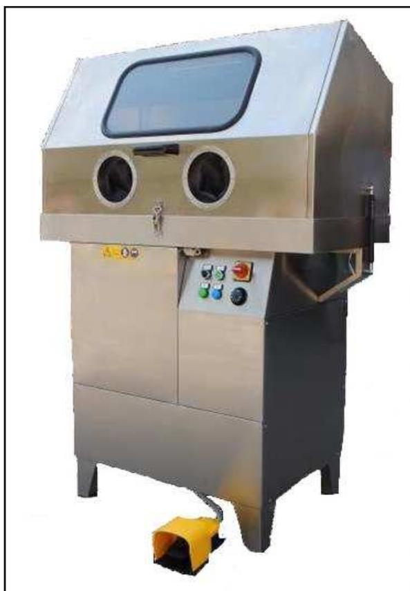
De conception innovante entièrement fabriquée en inox, la **FONTAINE DE DÉGRAISSAGE HAUTE PRESSION XL** possède une structure d'une extrême robustesse. Le système est composé d'une pompe haute pression, d'une résistance, d'un système de double filtration. Elle permet de réaliser un nettoyage des pièces mécaniques encombrantes de manière efficace, rapide et économique. La puissance de la pompe haute pression augmente la rapidité de dégraissage, même pour les pièces les plus complexes.
