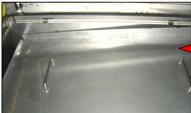
Panneau d'écoulement du nettoyant situé sous le plan de travail, permettant de diriger le fluide vers le filtre inox.
