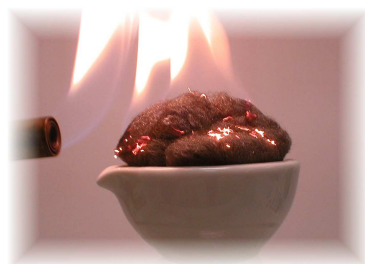
Exemple d'une laine d'acier non traitée avec SÉCURIFEU qui s'enflamme.
