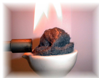
Exemple d'une laine d'acier traitée avec SÉCURIFEU sans inflammation.
