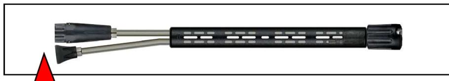
Double lance est l'accessoire complémentaire idéal à l'usage de l'injecteur by-pass. Une simple rotation de la manette permet de permuter les fonctions mousse et lavage haute pression. L'une des positions permet d'alimenter la tête pour la production de la mousse. L'autre position permet d'alimenter le tube de lance à plein débit nécessaire à la phase de rinçage.
