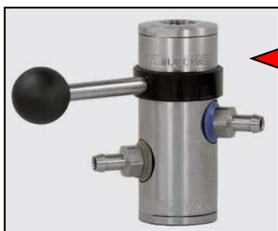
**Injecteur by-pass** : en phase haute-pression, ce module by-pass, injecteur de produit, conçu totalement en inox, permet un passage d'eau intégral grâce à 2 orifices parallèles de 8 mm chacun, évitant ainsi les pertes de pression (pertes de charge) lorsqu'il est utilisé à plein débit. Avec ce module, la production de mousse ne nécessite pas de lance mousse avec injection d'air. La quantité d'air nécessaire à générer la mousse est injectée directement dans le corps du module.
