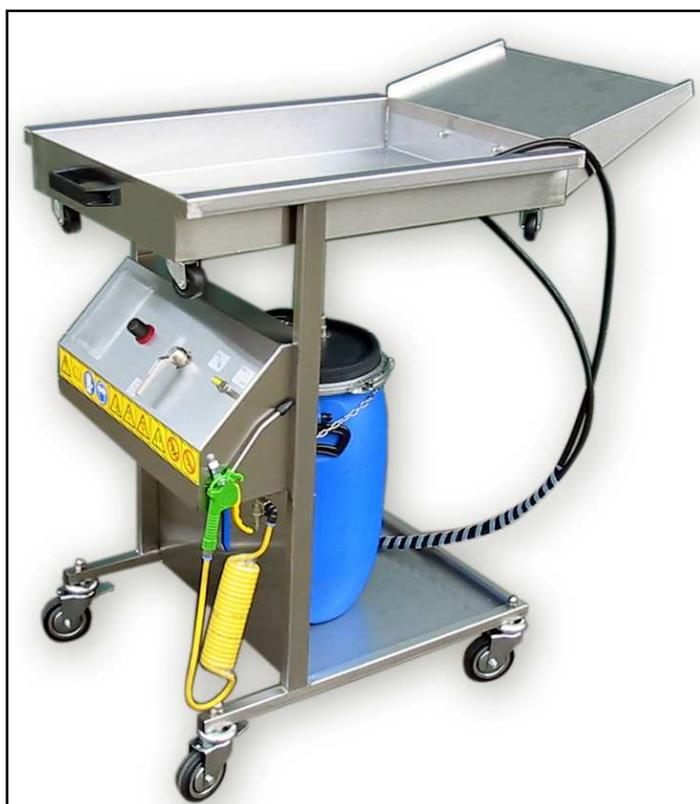
De conception innovante entièrement fabriquée en inox et d'une mobilité exemplaire, la **FONTAINE MOBILE DE NETTOYAGE DES SYSTÈMES DE FREINS** est composée d'une pompe fonctionnant à l'air comprimé, d'un bac multifonction amovible permettant son emploi aussi bien pour les voitures que pour les poids lourds, d'un système de filtration.
